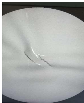
Gambar 6. Bentuk Fisik dan Hasil Radiograf Apron
